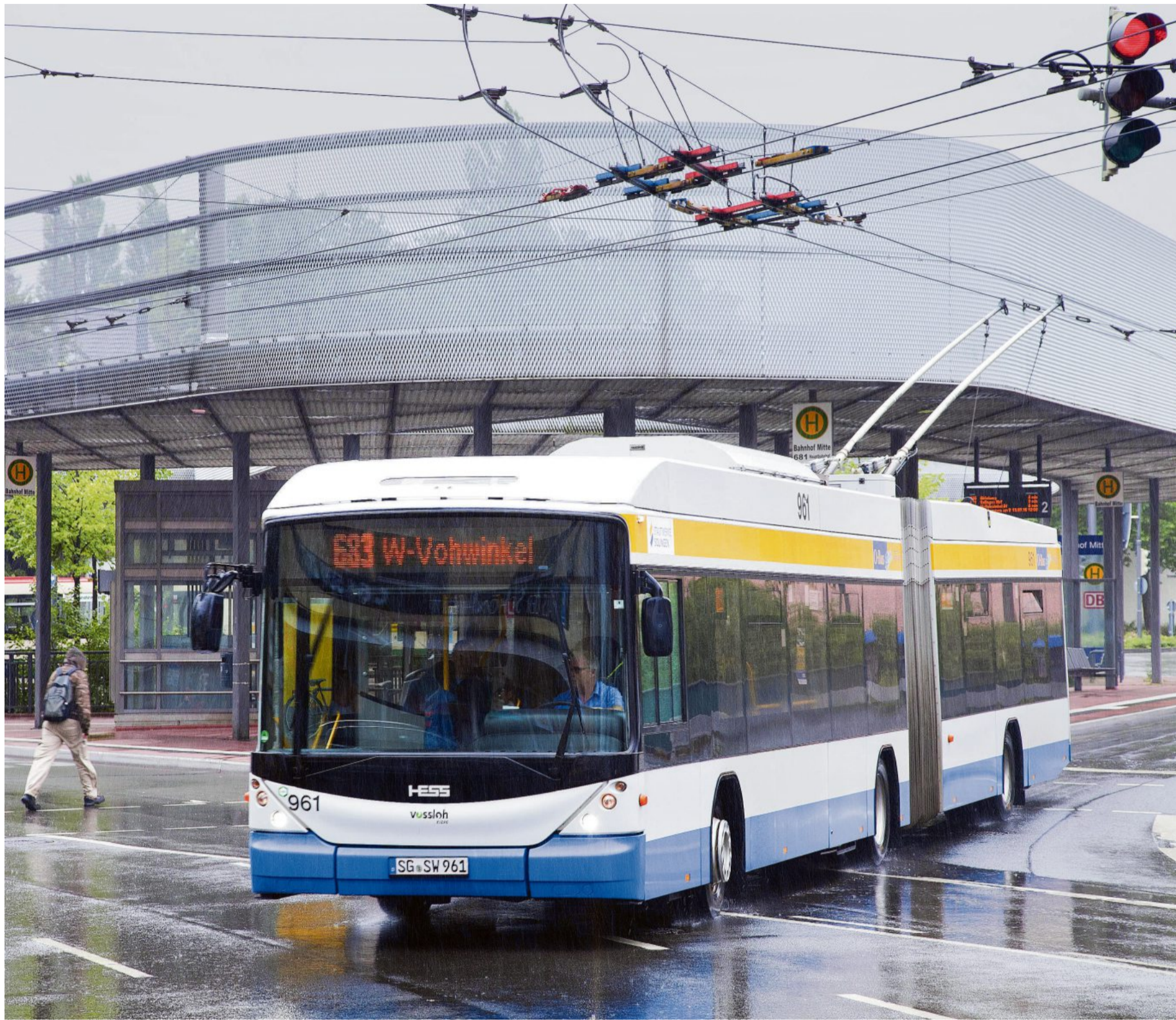
Strom-Abnehmer: Bisher haben Obusse wie dieser noch einen Diesel-Hilfsantrieb für Streckenabschnitte ohne Oberleitung. Künftig sollen sie dank eingebauter Speichertechnik überall in Solingen ausschließlich elektrisch fahren können – ohne dass das Oberleitungsnetz erweitert werden müsste. Foto: Schoepal
