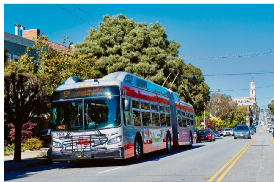
Klimaschutz für Kalifornien: Die neue Obus-Generation in San Francisco fährt ebenso wie die neuen Fahrzeuge in Solingen als „Selbstlader“ mit Speichertechnik Made in Germany ohne einen Diesel-Hilfsmotor. Foto: Kiepe Electric
